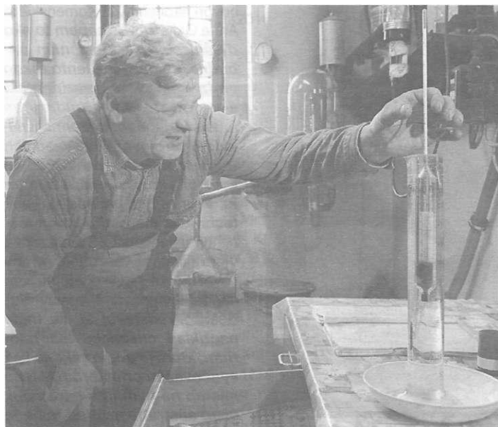
Vedúci pálenice Milan Baláž si uvedomuje, že ak si chce udržať renomé kvalitnej pálenice, nemôžu pri spracovaní kvasu nič zanedbať. Na snímke pri kontrole koncentrácie vypáleného alkoholu.
